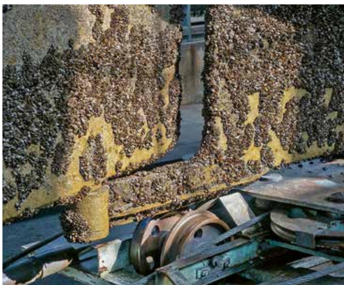
Das Unterwasserschiff der „Hohentwiel“ ist nach zehn Jahren im Wasser dicht mit Muscheln bewachsen. An manchen Stellen bis zu sieben Zentimeter dick.
